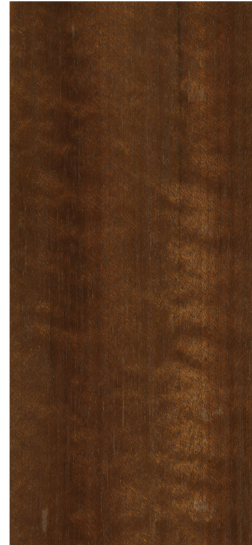
Débit sur faux quartier
